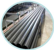
**TUBOS / SONDAS RANURADAS (BIOGAS Y DRENAJE)** - fabricado en polietileno de alta densidad, macroranurado con ranura 6 a 10 mm de ancho. Diámetros 63 a 315 mm, espesor de 5 a 35 mm.
