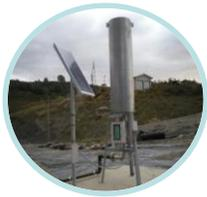
**ANTORCHA ESTÁTICA** - el uso de la antorcha estática de combustión de biogás está indicada en casos de rehabilitación de antiguos vertederos o en la obtención de nuevos vertederos, donde la capacidad de la producción de biogás es limitado debido a la reducción de la cantidad de residuos eliminados y donde no es posible tener la energía eléctrica disponible para la alimentación de diferentes dispositivos.
